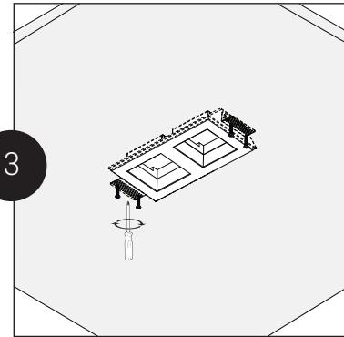
Установите корпус (поз. 1) в отверстие и закрепите его с внешней стороны потолка саморезами, идущими в комплекте (поз. 4).
