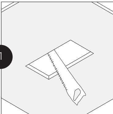
Сделайте отверстие в гипсокартонном потолке, соответствующей выбранной модели (размер AxB) (см. таблицу).
