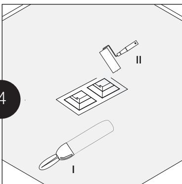
После установки следует зашпаклевать швы, покрасить потолок и гипсовый крпус светильника.
