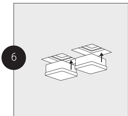
Установите световые модули (поз.2) в корпус светильника на магнитную планку.
